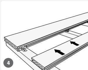
Schieben Sie sanft die zweite Diele gegen alle Clips und stellen Sie sicher, dass alle Clips in die seitliche Nut der zweiten Diele passen.
