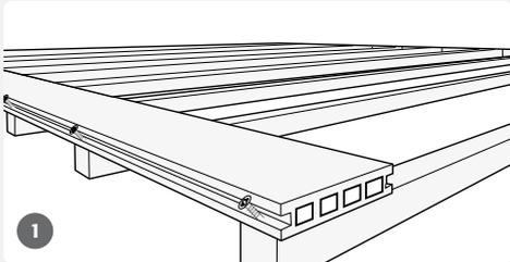
Befestigen Sie die erste Diele. Setzen Sie Aufnahmebohrungen in einem Winkel von 45° zwischen die Nutwangen am Rand der Diele in die Mitte der Unterkonstruktion. Schrauben Sie die Diele fest. Die Dielen sollten in Längsrichtung ein Gefälle von 1% (1 cm/m) aufweisen.
