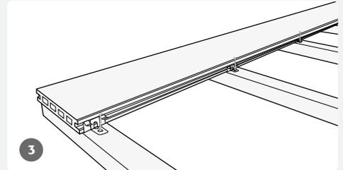
Bohren Sie durch das Loch des Clips vor und schrauben Sie diesen an der Mitte der Unterkonstruktion fest.
