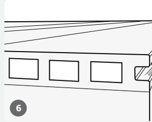
Bei der letzten Diele setzen Sie Aufnahmebohrungen in einem Winkel von 45° zwischen die Nutwangen am Rand der Diele in die Mitte der Unterkonstruktion. Schrauben Sie die Diele fest.
