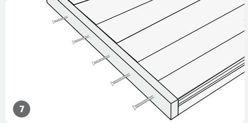
Falls Sie ein Abschlussprofil an die Dielenenden montieren müssen, setzen Sie zunächst die Vorbohrung durch das Abschlussprofil in die Dielseite oder Unterkonstruktion, sodass das Abschlussprofil bündig mit der Dielenoberseite verschraubt werden kann.
